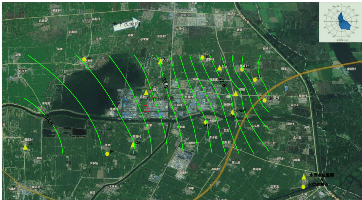
图 6.3-6 引用地下水等水位线图（2021 年 11 月）
